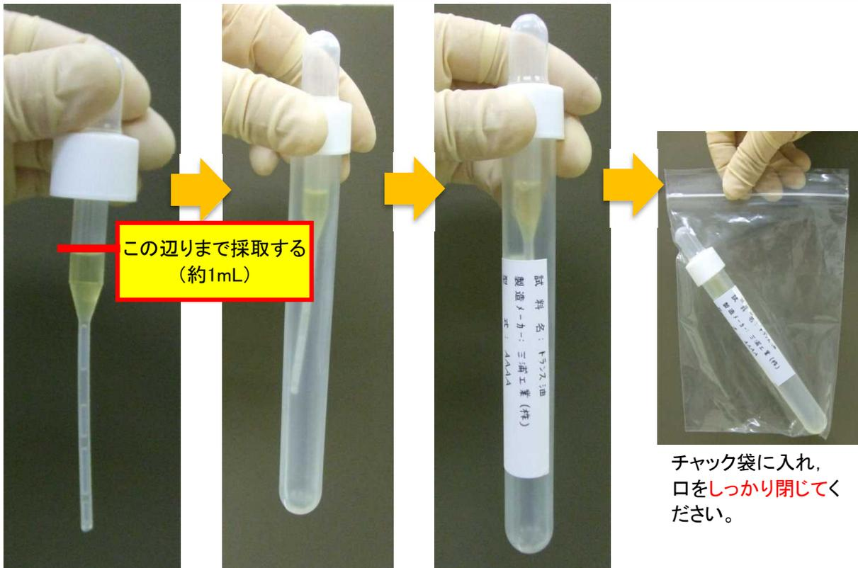
上図スポイトの**矢印の辺りまで絶縁油を1回だけ**採取してください(約1mlとなります)。
