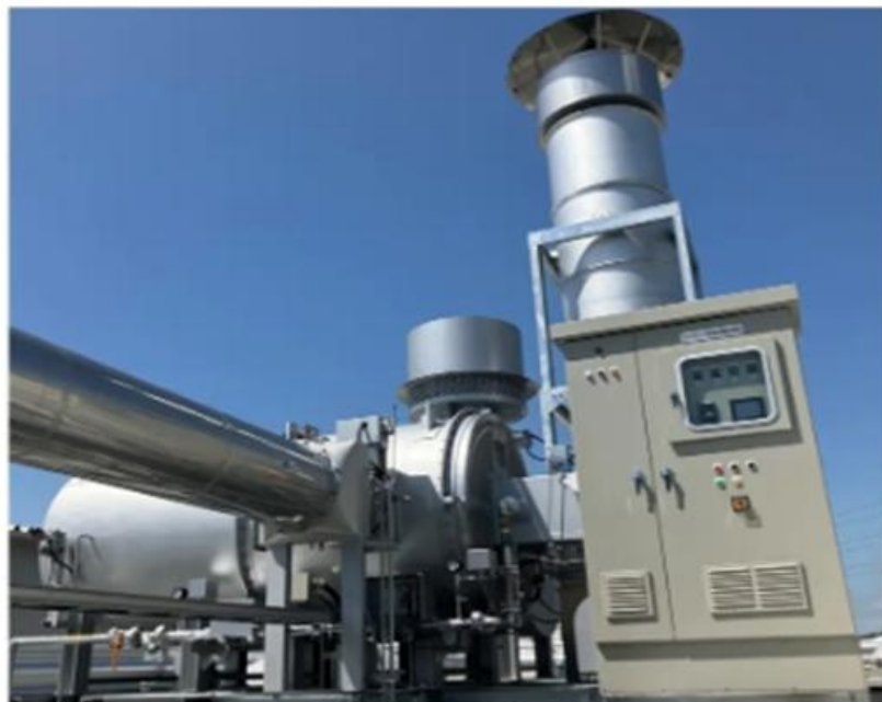
← 船舶用アンモニアDFバーナ搭載ボイラ試験設備 (愛媛県松山市 三浦工業堀江工場)
