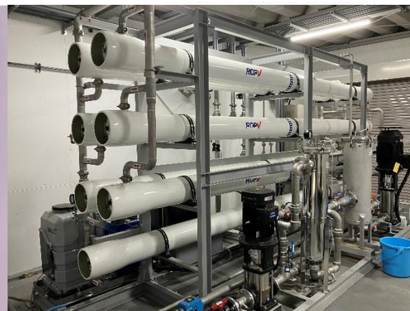
高回収率リネン廃水リサイクルシステム(MF+RO)
