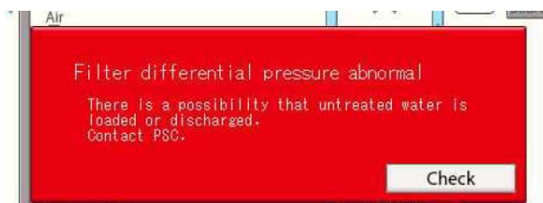
フィルタ差圧異常表示画面
