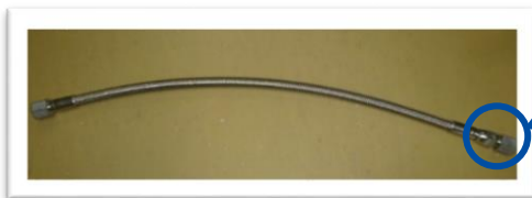
フレキシブルチューブ 端部ソケットに船級刻印
