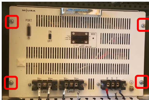
図 4 4kW 電源固定ネジ取り外し
