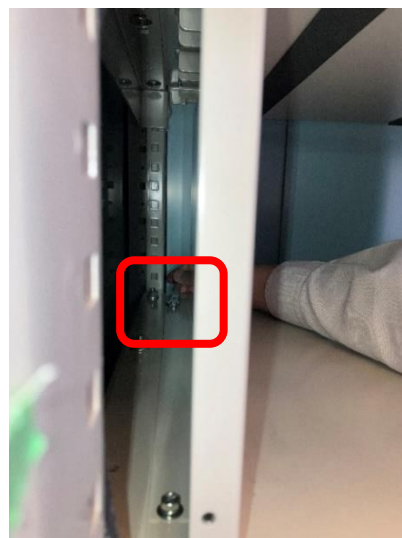
図 9 後ろ 2 点のボルトの取り外し
