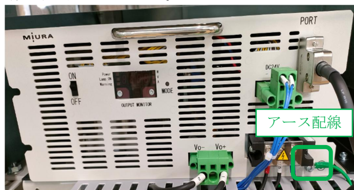
図 25 8kW 電源 正面配線(アース配線)取り付け箇所
