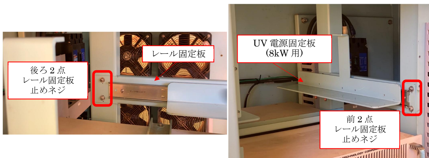
図 12 レール固定板及び UV 電源固定板(8kW 用)の取り付け
