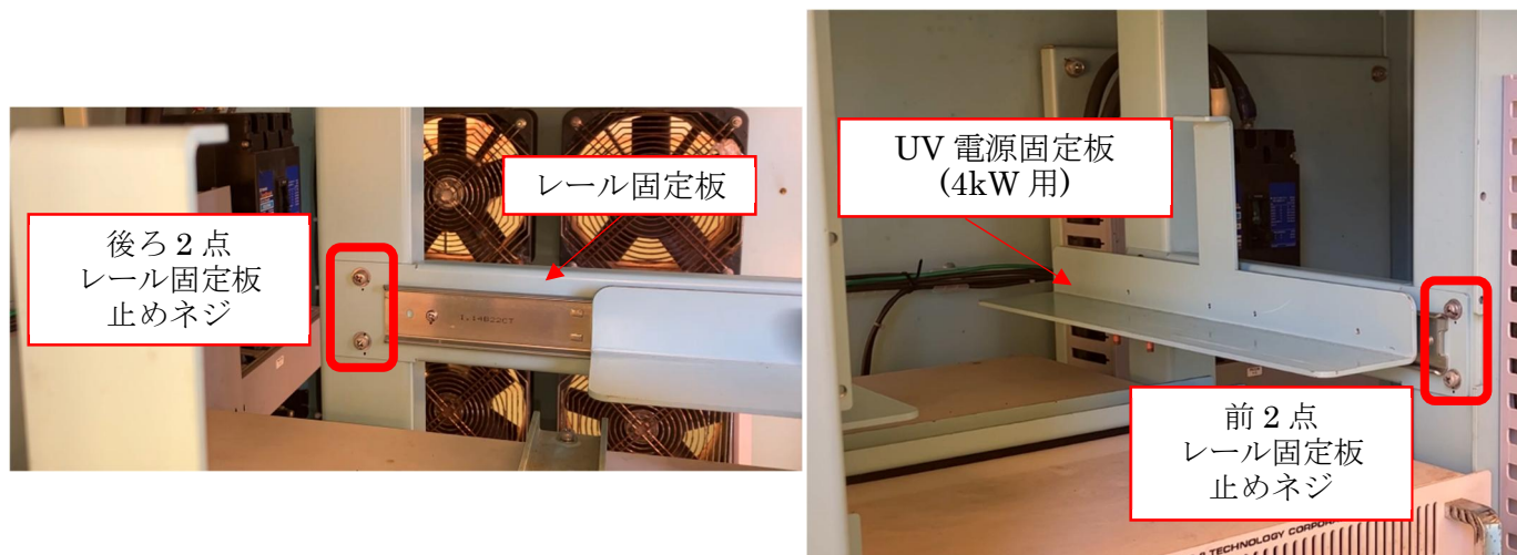
図 9 レール固定板及び UV 電源固定板(4kW 用)の取り外し
