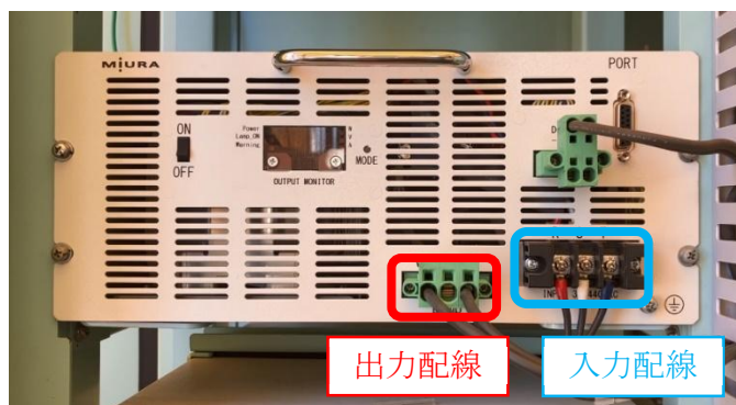
図 20 8kW 電源 正面配線(入力配線・出力配線)取り付け箇所
