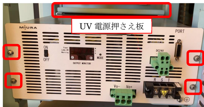
図 15 8kW 電源固定ネジ及び UV 電源押さえ板の取り付け
