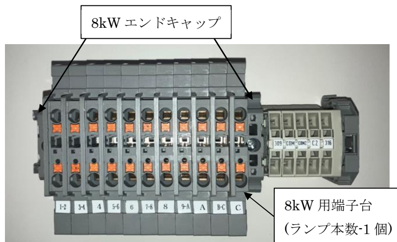
図 6 UV リアクタへ 8kW 用端子台及びエンドキャップの取り付け
